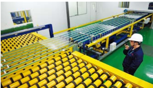
中国建材超薄玻璃生产线，已生产出目前世界上最薄的0.2毫米超薄电子玻璃
