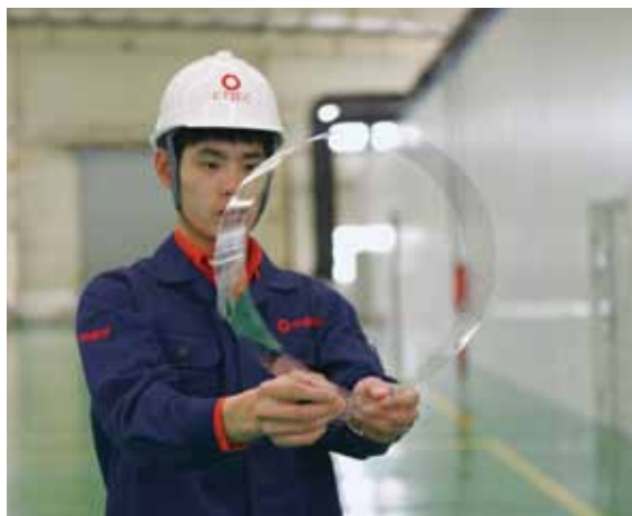
国内最薄0.2毫米超薄玻璃
